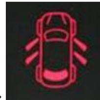
« Montrez le voyant signalant la mauvaise fermeture d'une portière »
